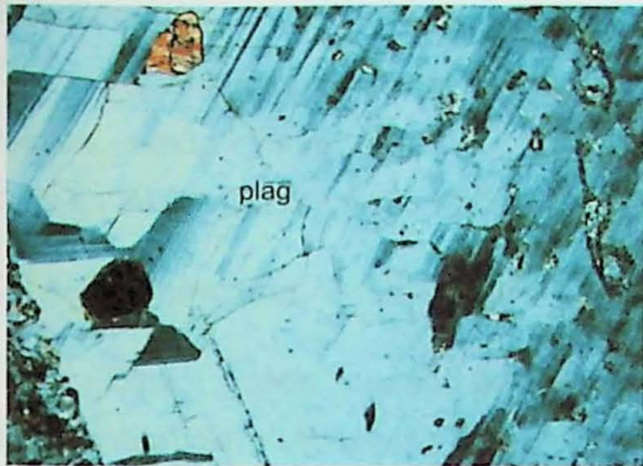
Fig.43 – Cristal zonado de plagioclásio, em diabásio, com diminuição de inclusões do núcleo para a borda. Aumento de 4X, polarizadores cruzados. Lado maior 3,25 mm. UB-16d
