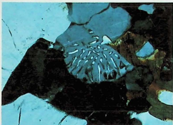
Fig.28 – Mirmequita em plagioclásio em contato com feldspato alcalino. Aumento de 10X, polarizadores cruzados. Lado maior 1,3 mm. UB-21 - mangerito.
