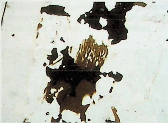
Fig.37 – Biotita simplectítica junto de mineral opaco. Aumento de 4X, polarizadores paralelos. Lado maior 3,25 mm. UB-27a – granito avermelhado.
