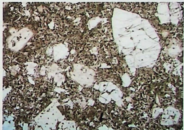
Fig.46 – Textura porfírica de olivina basalto. Cristais de piroxênio zonado no centro e canto superior esquerdo da foto. Aumento de 4X, polarizadores paralelos. Lado maior 3,25 mm. UB-84
