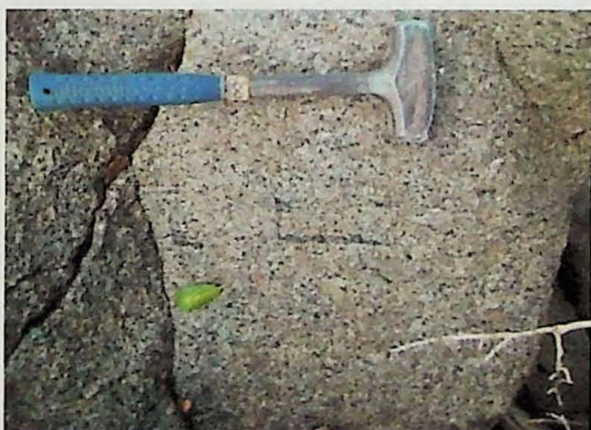
Fig.08 - Foliação em mangerito evidenciada pela orientação de minerais e aglomerados máficos.
